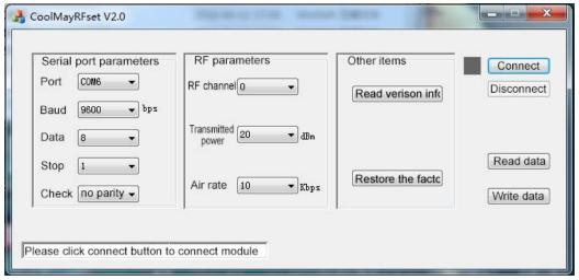
Setting CM-RFM radio module parameters
